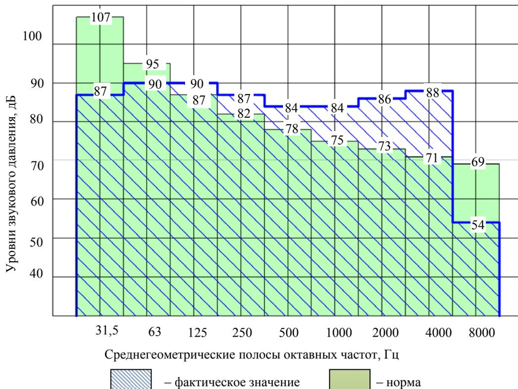
Рис. 3. Спектральная характеристика уровня звукового давления на рабочем месте станочника форматной обрезки кромок плит
