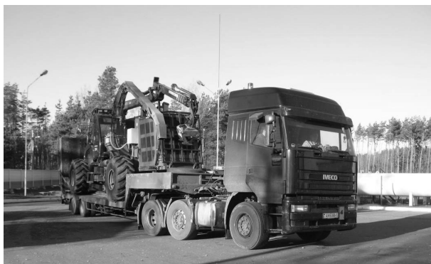
Рис. 2. Транспортировка рубильной машины при помощи автотягача
