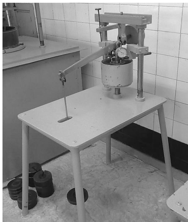
Рис. 4. Устройство для определения прочностных характеристик
