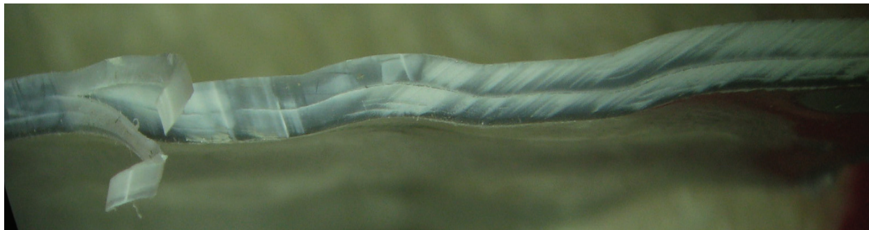
Рис. 3. Вид дефекта в разрезе в слое полимера, из которого изготовлены поддоны, в поле зрения микроскопа МСП-2 (увеличение до 54х)
