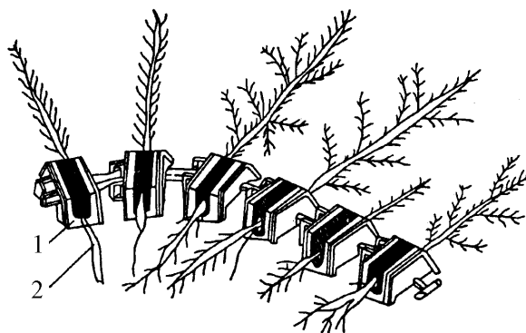
Рис. 6.11. Кассетный сеянцедержатель: 1 – звено кассеты; 2 – сеянец
