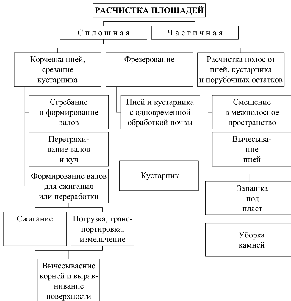
Рис. 1.1. Виды расчистки лесных площадей
