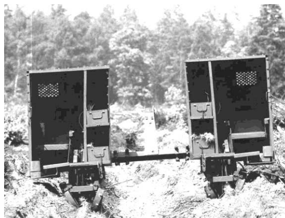
Рис. 6.9. Лесная сажалка СЛП-2: 1 – сошник; 2 – брус навески; 3 – рама; 4 – кабина; 5 – сидение сажальщиков; 6 – посадочный аппарат; 7 – ящик для семян; 8 – стойка-подставка; 9 – подножка; 10 – ящик для инструмента; 11 – опорный башмак
