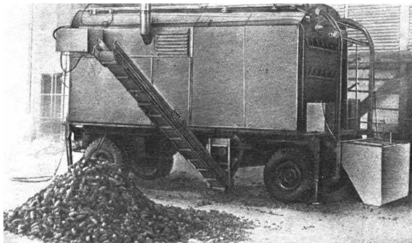
Рис. 4.6. Передвижная шишкосушилка ШП-0,6 (ШП-1,5)
