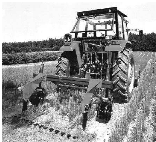
Рис. 5.33. Процесс работы выкопочного агрегата РК/ВК-1,2, Польша
