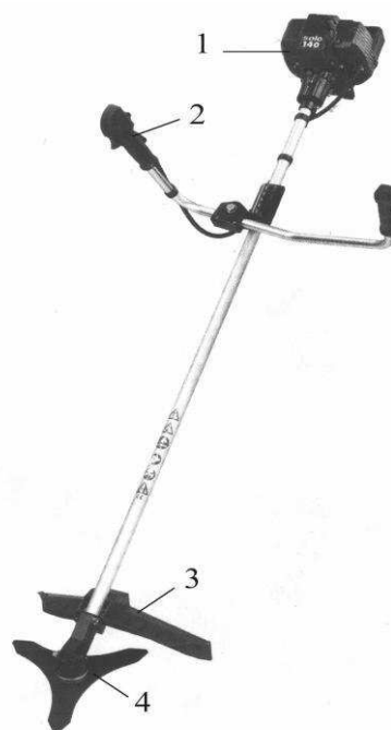
Рис. 1.36. Моторная коса: 1 – двига- тель; 2 – рукоять управления; 3 – за- щитный кожух; 4 – режущий нож
