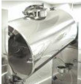
Для осуществления продольного смещения (вдоль образующей барабана) ось вращения располагают наклонно к образующей барабана (пьяная бочка) или перпендикулярно. Применяют V-образные барабаны (угловой смеситель). Достоинство – улучшается интенсивность перемешивания, недостаток – неравномерные нагрузки на подшипники. Используют также конические, гранёные формы корпусов и др.
