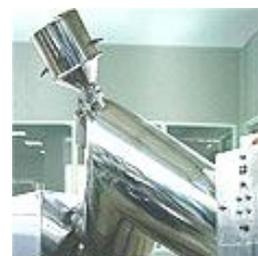
Окружная скорость вращения барабана обычно находится в пределах  $0,17 \div 1$  м/с. При больших скоростях центробежная сила, действующая на частицы материала, оказывается сравнима с силой тяжести и движение материала прекращается.
