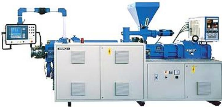
В зависимости от применения червячных машин для проведения тех или иных технологических процессов они выполняются в нескольких разновидностях (смесители-пластикаторы, пластикаторы-грануляторы и, наконец, собственно экструдеры). Для проведения всех необходимых операций (от подготовки композиции до выдавливания через оформляющий мундштук готового продукта) могут последовательно устанавливаться несколько специализированных червячных машин, например смеситель → пластикатор → гранулятор → экструдер.
