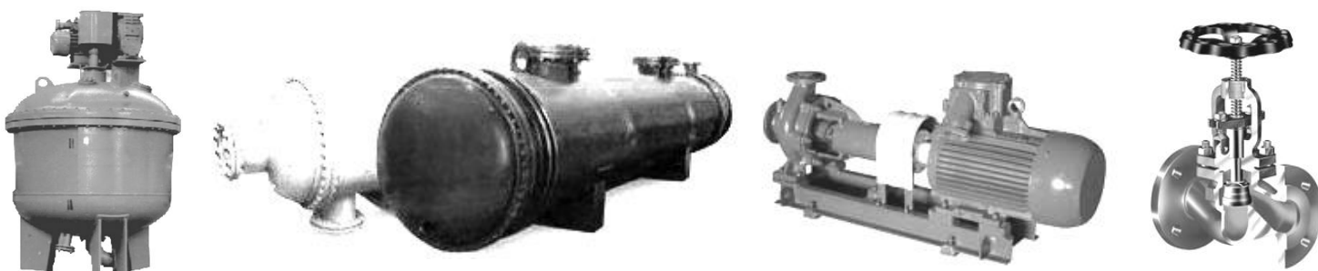
Рис. 3. Применение сальниковых уплотнений (аппараты с мешалками, теплообменники, насосы, запорно-регулирующая арматура и др.).
