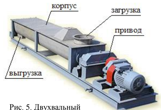
Рис. 5. Двухвальный смеситель непрерывного действия
