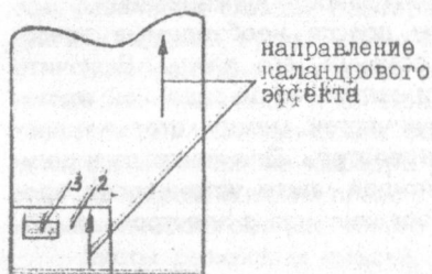
Рис. 5: 1 - лист резиновой смеси; 2 - заготовка для вулканизации пластины; 3 - бумажная этикетка
