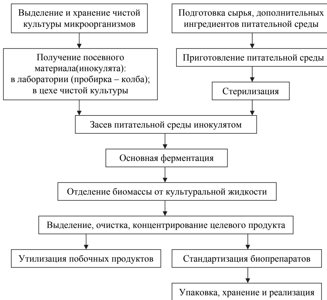
Рис. 1.6. Общая схема получения аминокислот микробиологическим методом
