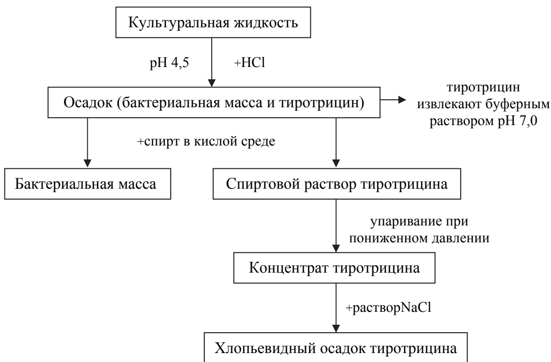
Рис. 1.18. Технологическая схема получения тиротрицина
