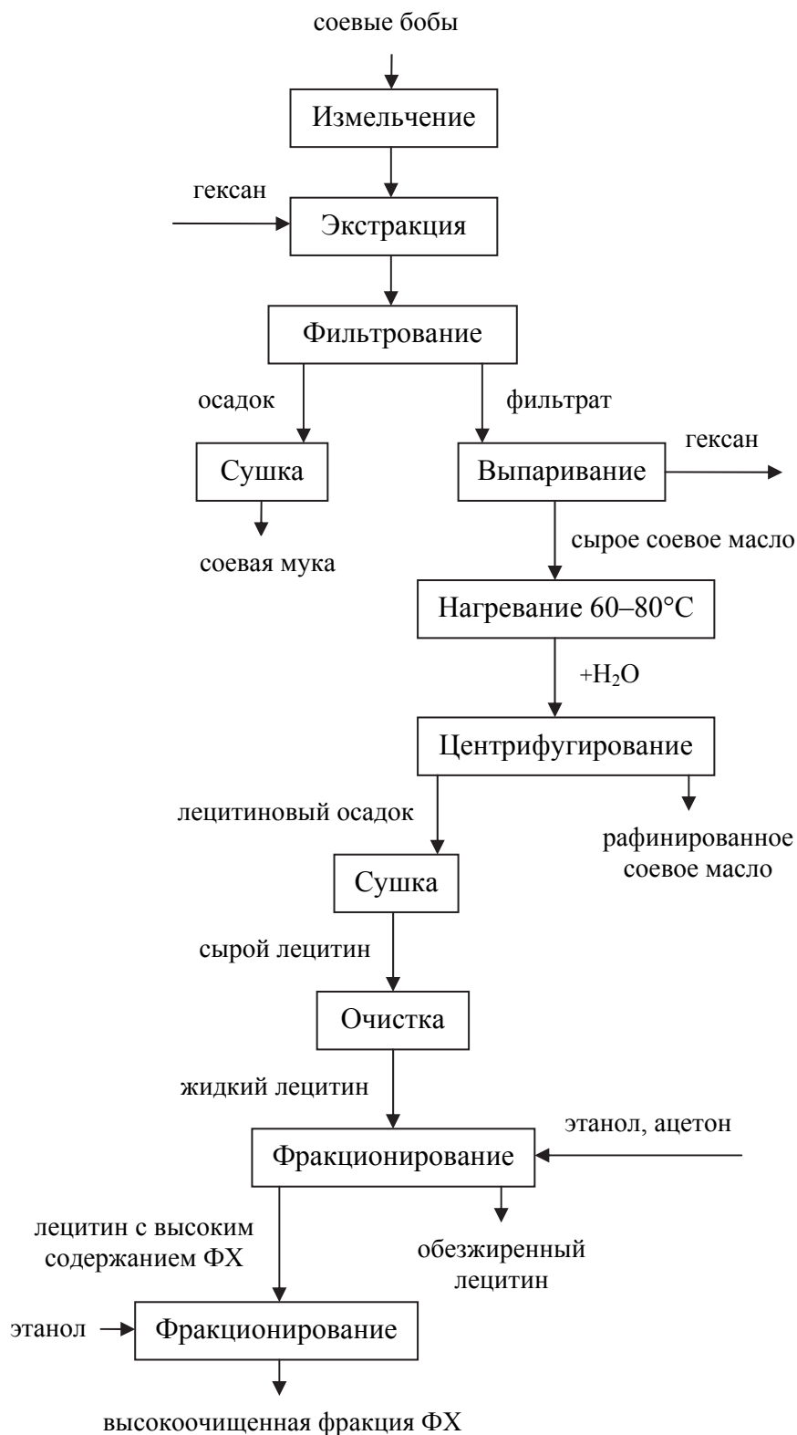
Рис. 4.5. Технологическая схема получения лекарственных средств на основе ЭФЛ
