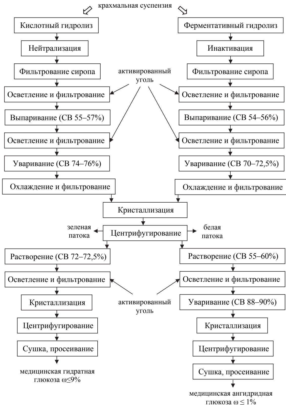
Рис. 3.2. Технологическая схема получения медицинской глюкозы
