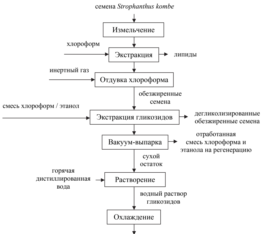
Рис. 6.16. Технологическая схема получения строфантина К (окончание см. на с. 91)
