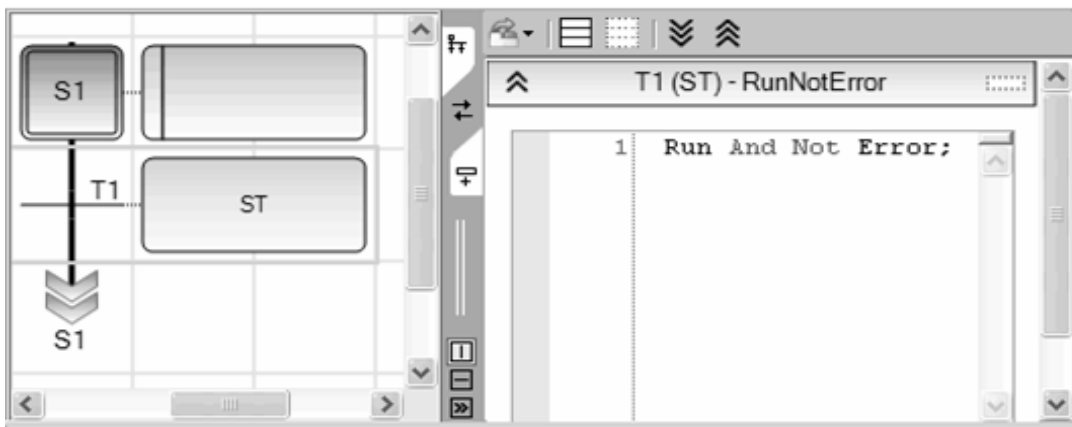
Рис. 5.13. Программирование условий переходов на ST
