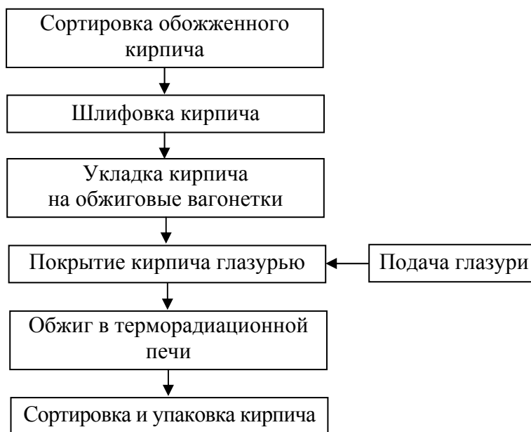
Рис. 4.2. Схема производства глазурованного кирпича
