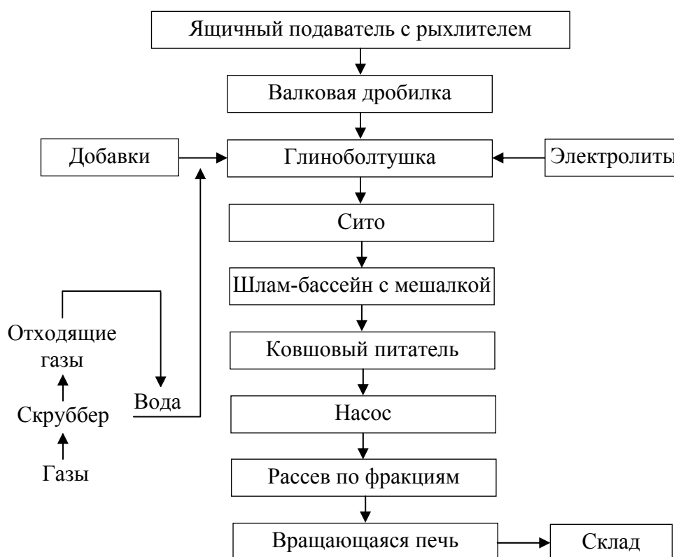
Рис. 8.3. Подготовка массы при шликерном способе производства керамзита
