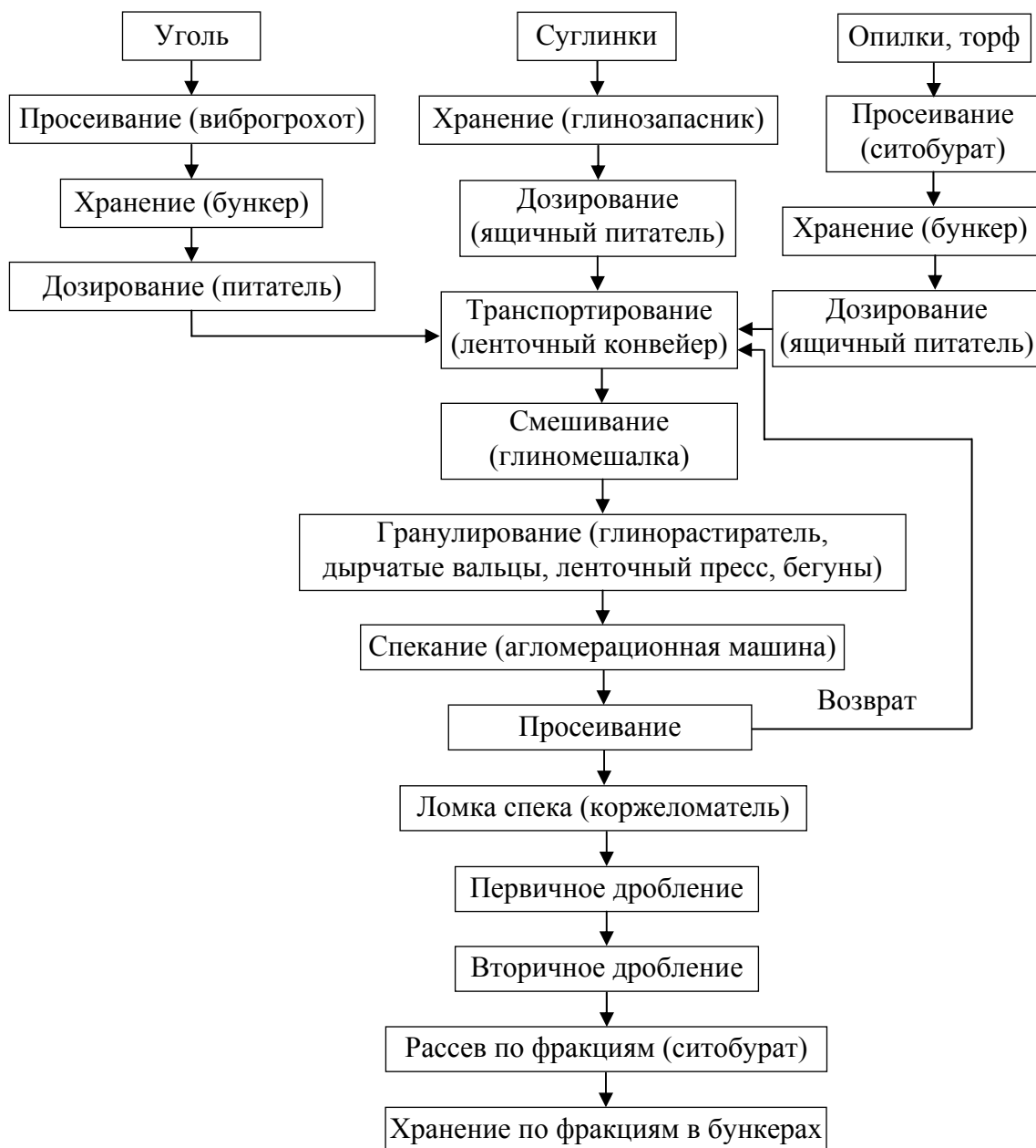
Рис. 8.1. Технологическая схема получения аглопорита
