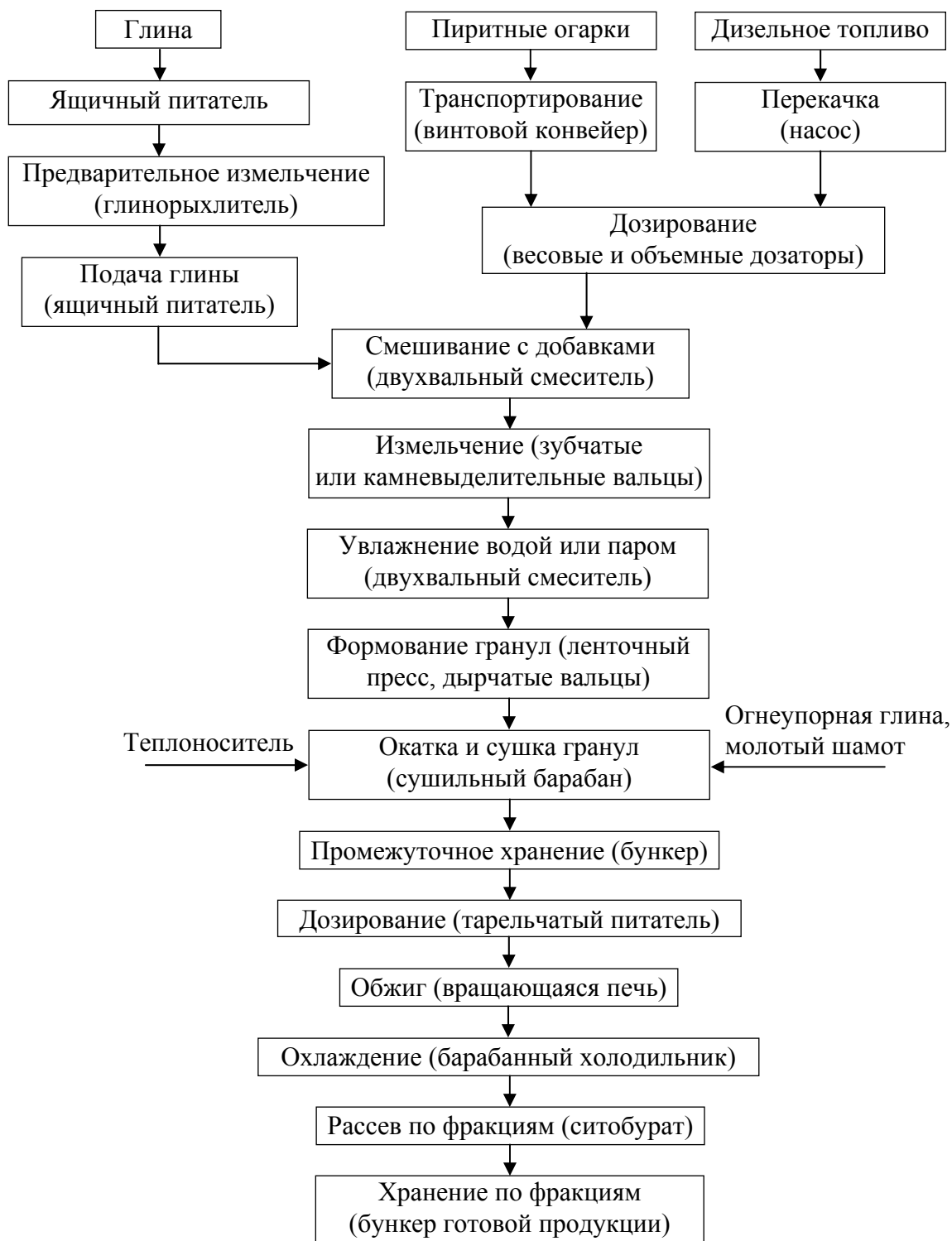
Рис. 8.4. Технологическая схема производства керамзита пластическим способом
