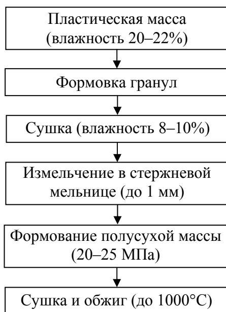
Технологическая схема приготовления массы для полусухого прессования
