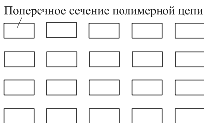
Рис. 2.21. Схематическое изображение разреза кристаллической области пачки макромолекул целлюлозы
