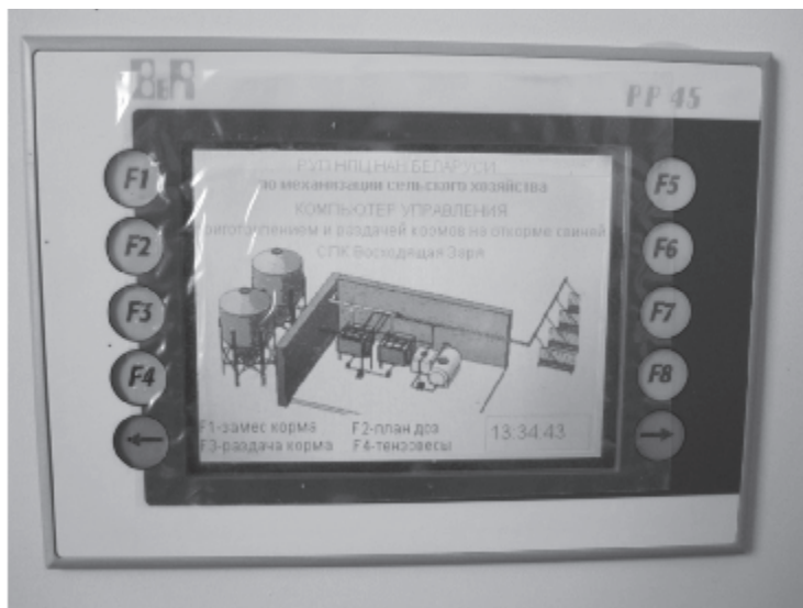
Рисунок 1 – Общий вид панели оператора системы управления раздачей жидких кормов на свиноводческом комплексе
