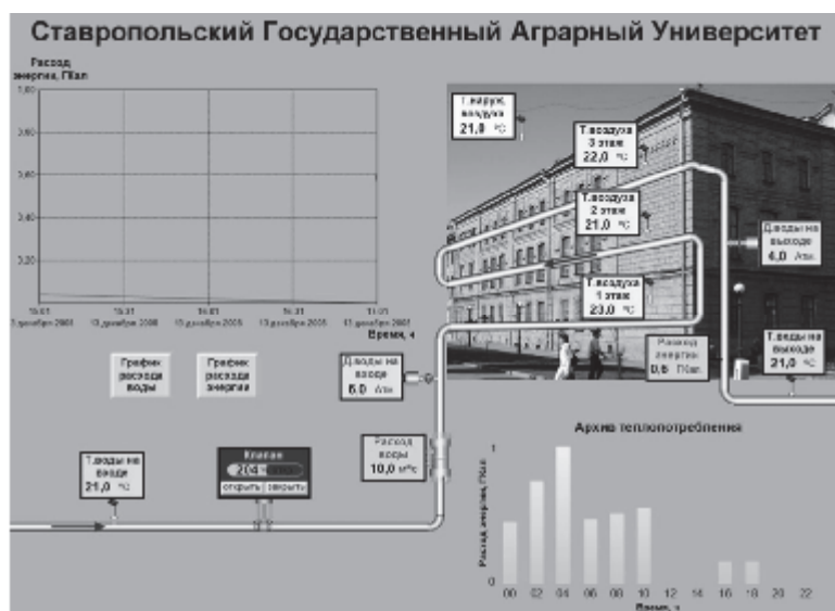
Рисунок 2 – Пример немосхемы управления теплоснабжением учебного корпуса
