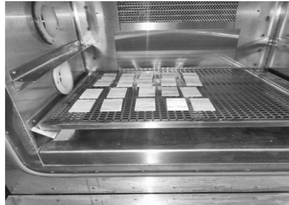
Рис. 1. Закладка образцов в климатическую камеру
