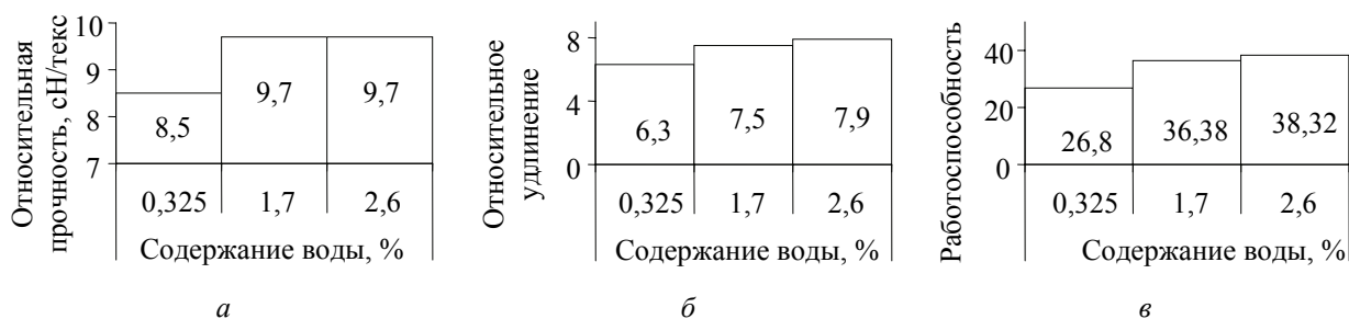
Рис. 3. Влияние содержания воды в реакционной среде на прочность (а), удлинение при разрыве (б) и работоспособность (в) волокон на основе поли[АН-со-МА-со-АМПС]
