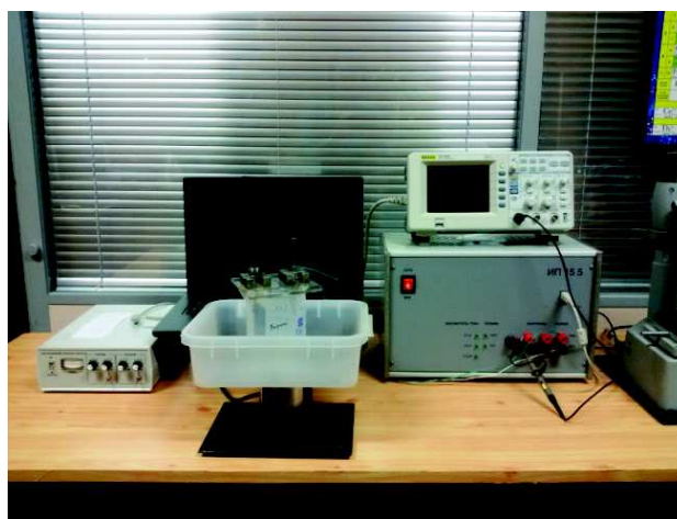
Рисунок 1 – Лабораторное оборудование для формирования электрохимических покрытий: источник нестационарного электролиза и ультразвуковая ванна
