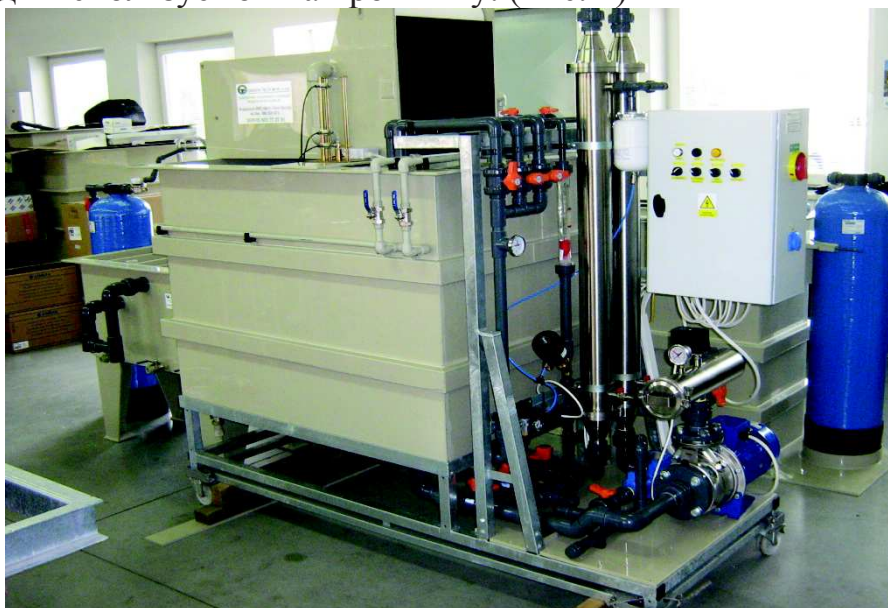
Рисунок 1 - Установка микрофльтрации (для удаления нефтепродуктов из электролитов обезжиривания).
