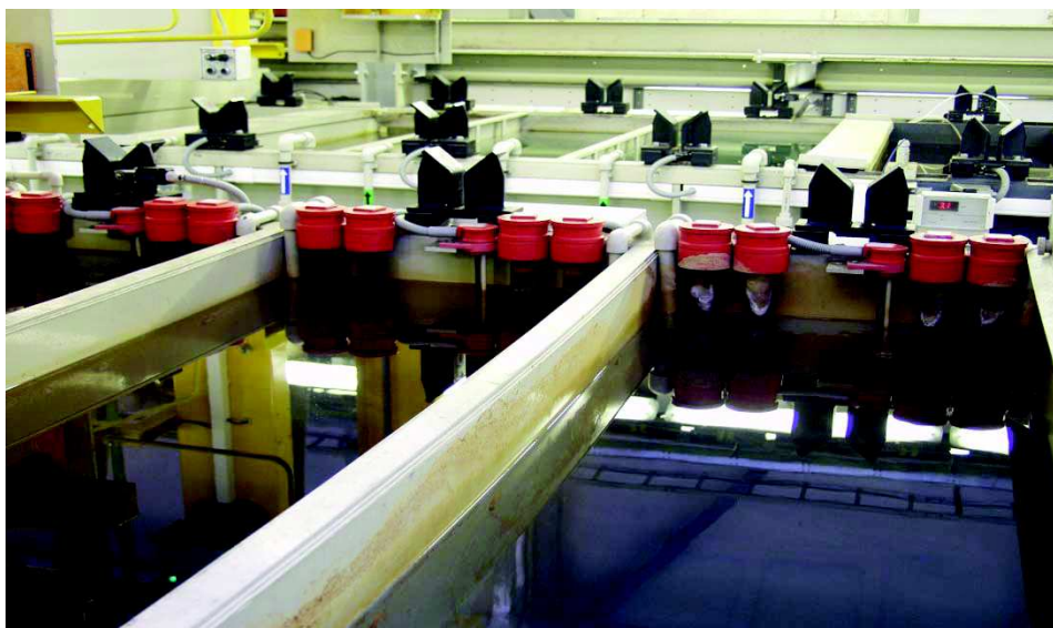
Рисунок 2 - Система трёхкаскадных промывок деталей
