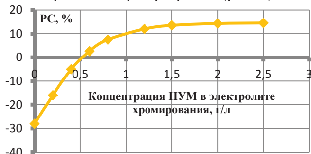
Рисунок 1 - Изменение рассеивающей способности электролита хромирования в зависимости от концентрации НУМ-А в электролите ( i_k = 50 \text{ А/дм}^2 , T = 55^\circ\text{C} )
