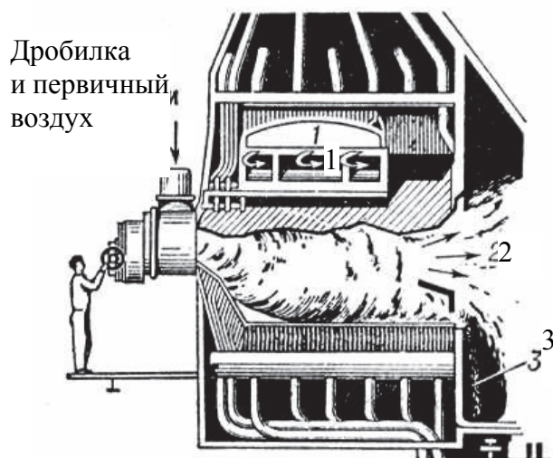
Рис. 4.10. Горизонтальный предтопок: 1 — ввод вторичного воздуха; 2 — выход продуктов сгорания в топку; 3 — выход жидкого шлака
