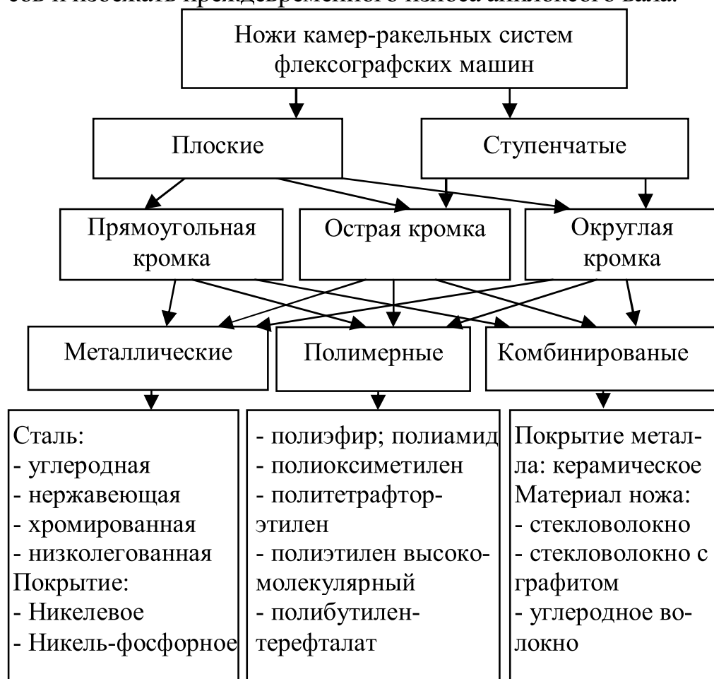
Рис. Классификация ножей камер-рапельных красочных систем флексографских машин
