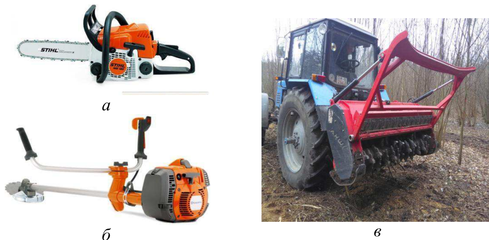
Рисунок 1 – Оборудование для проведения рубок реконструкции а – бензиномоторная пила, б – мотокустоторез, в – мульчер
