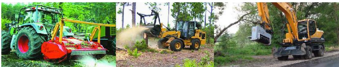
**Рисунок 2 – Классификация мульчеров по типу шасси**
