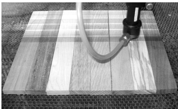
Рис. 4. Лазерное резание образцов древесины
