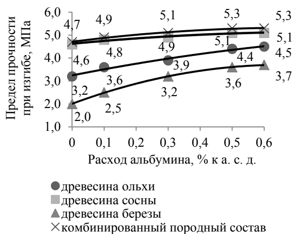
Рис. 2. Влияние расхода альбумина на предел прочности пеллет при изгибе
