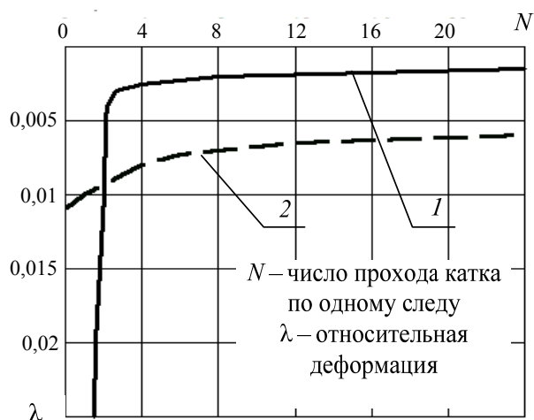
Изменение деформаций связанного грунта оптимальной влажности: 1 – необратимой; 2 – обратимой
