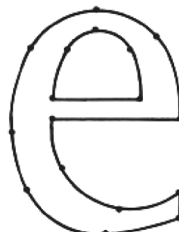
Рис. 6. Способ кодирования информации о начертании шрифтовых знаков при контурном описании изображения знаков
