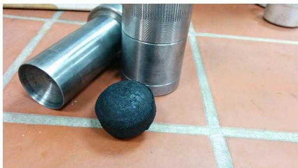
**Рисунок - Образец брикетированного топлива**
