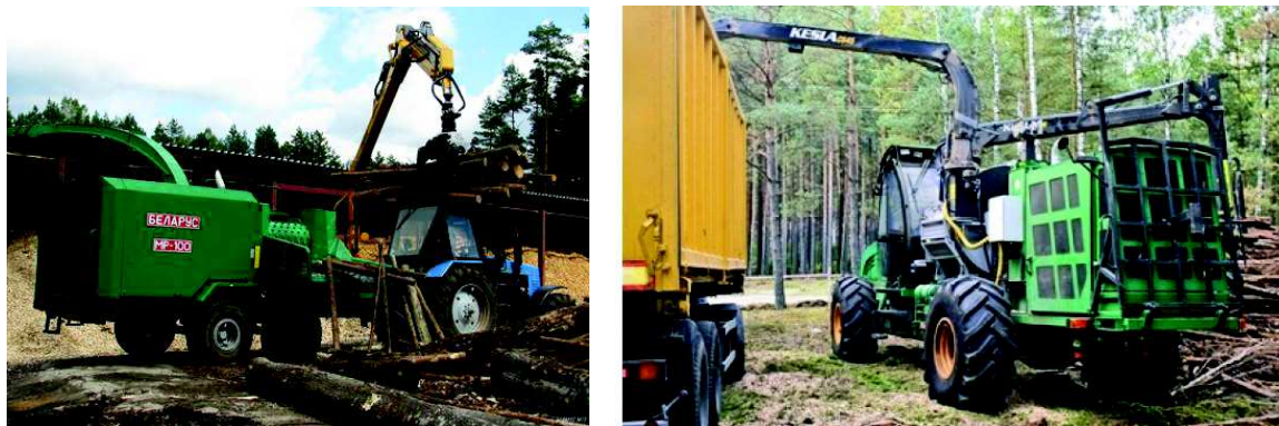
Рисунок 1 – Мобильные барабанные рубильные машины с гидроманипуляторами: а – прицепная Беларусь МР-100 ОАО «Минский тракторный завод»; б – самоходная Амкодор-2904 ОАО «Амкодор»
