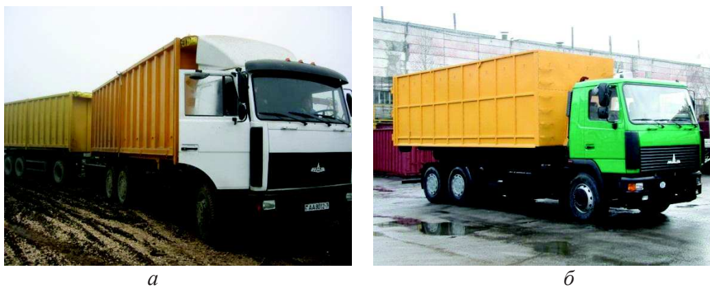
Рисунок 2 – Автомобили для перевозки щепы ОАО «Минский автомобильный завод»: а – прицепной автопоезд-щеповоз МАЗ-5516+МАЗ-8561; б – автощеповоз с механизмом самозагрузки-разгрузки контейнера типа «мультилифт» МАЗ-6501
