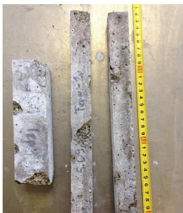
**Рисунок 4 - Образцы после ускоренного испытания на щелочно-силикатную реакцию**
