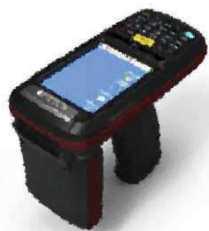
а - RFID-порталы; б - RFID-тоннели; с) RFID-терминал сбора данных RFID- считыватель
