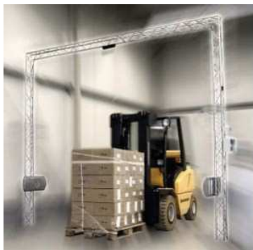
Рисунок 1 - Аппаратная часть RFID – системы
