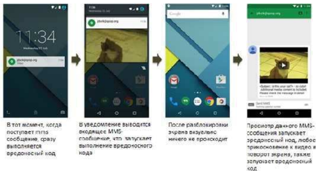
Рисунок 1 – Пример использования вирусом уязвимости типа Stagefright
