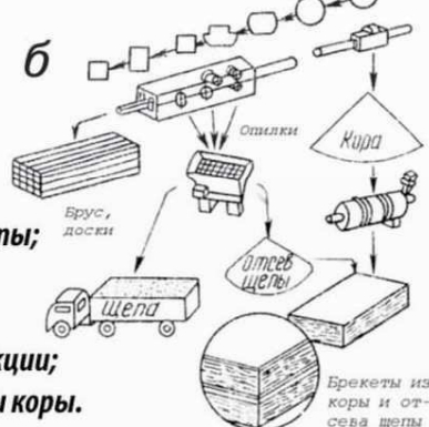
Комбинат комплексной переработки мелкотоварного пиловочного сырья: а – участок окорки и сортировки сырья; б – технологическая схема переработки сырья.
