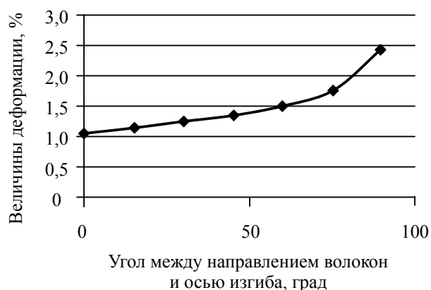
Рис. 2. Зависимость величины деформации от угла между направлением волокон и оси изгиба
