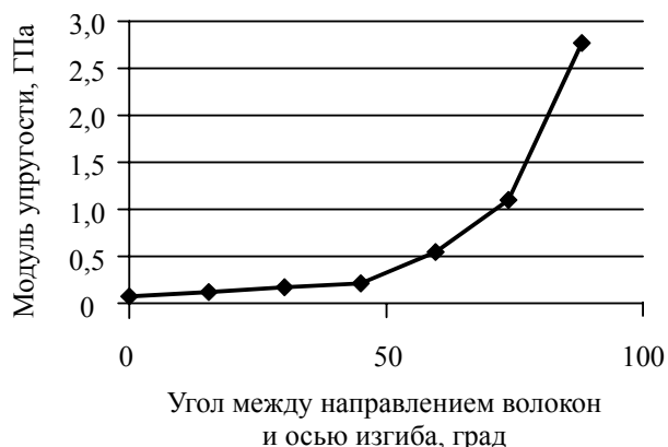
Рис. 1. Зависимость модуля упругости от угла между направлением волокон и осью изгиба
