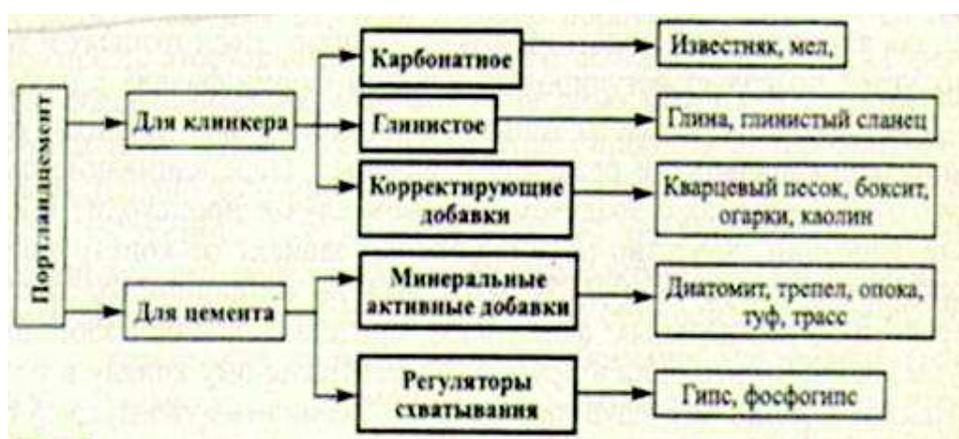
Рисунок 1 – Компоненты для производства
