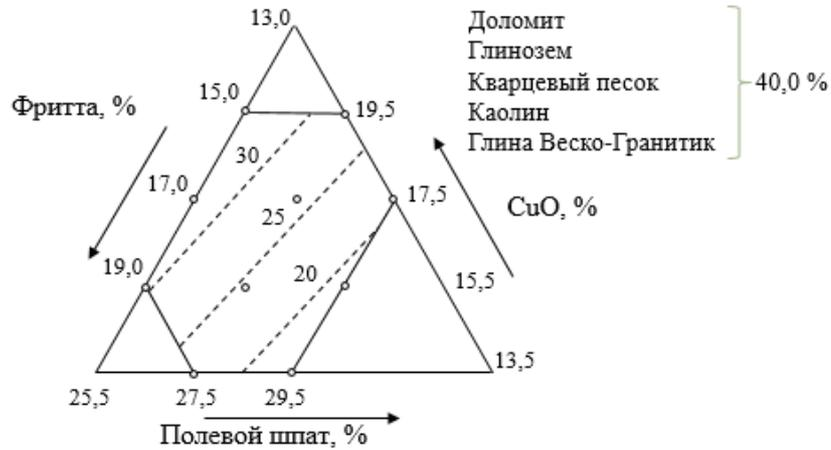
Рисунок 1 – Линии равных значений блеска (%) глазурей
