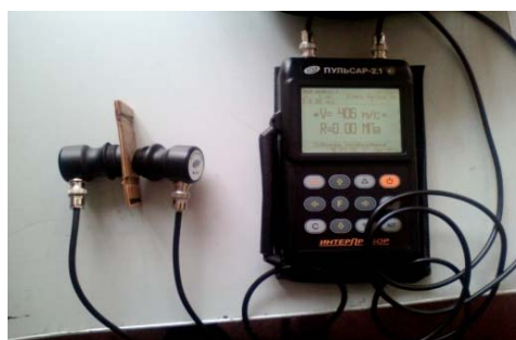
Рис. 2. Измеритель времени и скорости распространения ультразвука «Пульсар-2»
