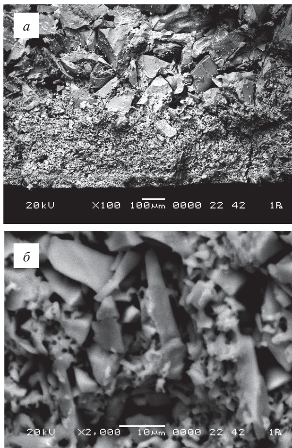
Рис. 4. Структура многослойного микрофильтрующего материала (а) и мембранного покрытия (б)
