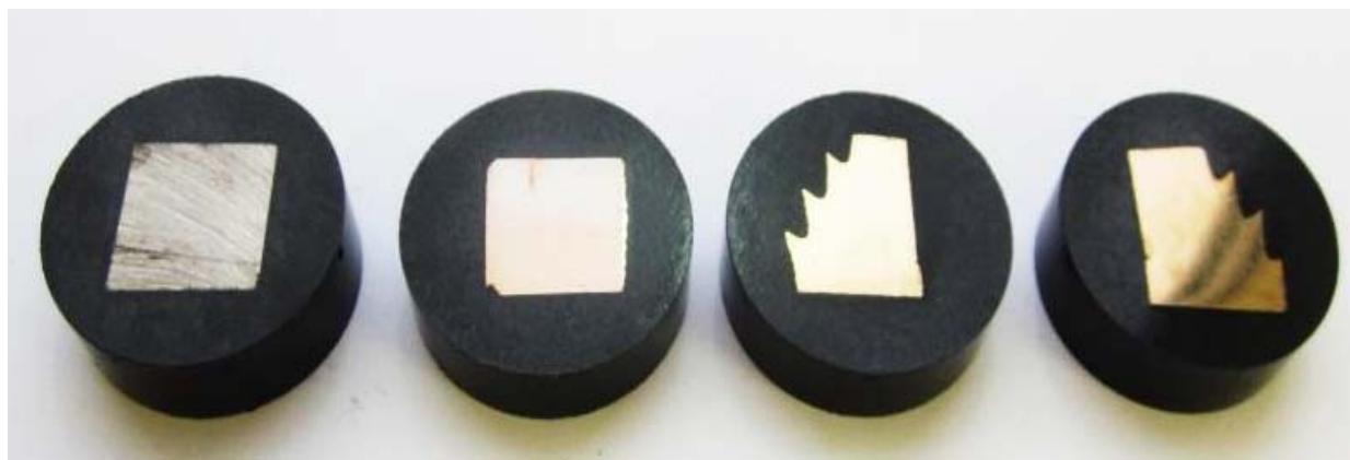
Рис. 1. Внешний вид запрессованных образцов (слева направо: без покрытия (БП), AT72, TK13, TK12)
