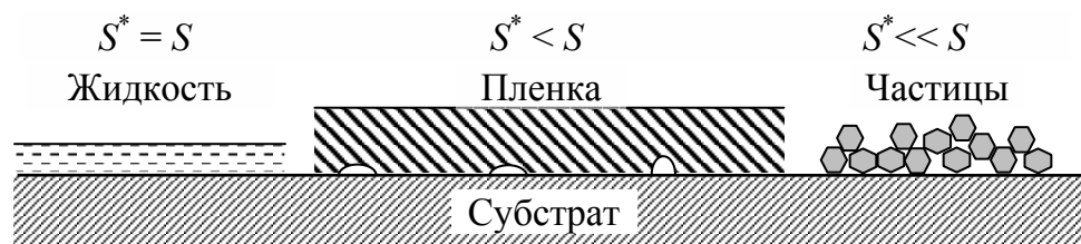
Рис. 4.23. Адгезия жидкости, пленки и частиц: S^* – площадь реального адгезионного контакта; S – площадь поверхности субстрата, на которую нанесен адгезив
