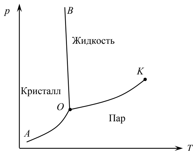
Рис. 3.4. Диаграмма состояния однокомпонентной системы в случае \Delta V_{пл} < 0
