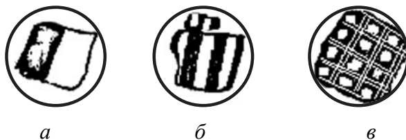
Рис. 22. Двойники под микроскопом: а – простой двойник; б – полисинтетический двойник; в – система пересекающихся двойников
