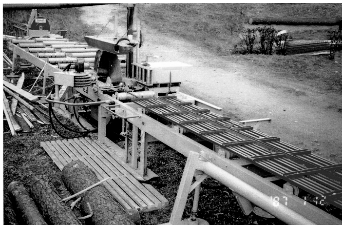
Рис. 100. Переработка бревен на однопильном станке: a – схема переработки; б – общий вид станка
