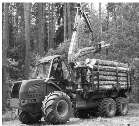
Рис. 35. Способы доставки сырья на лесозавод: a – выгрузка лесоматериалов из полувагона грейфером; 1 – опорные стойки, 2 – дополнительные стойки; б – форвардер «Амкодор 2661» с гидроманипулятором
