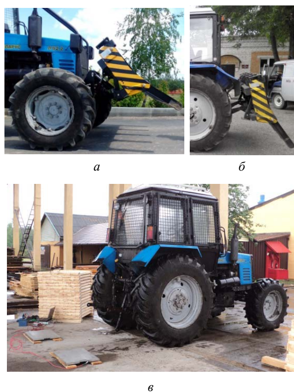
Рис. 4. Установка технологического оборудования для сбора лесосечных отходов: а – установка технологического оборудования на переднем бруске трактора; б – установка оборудования на задней навеске; в – определение реакций под колесами базового трактора
