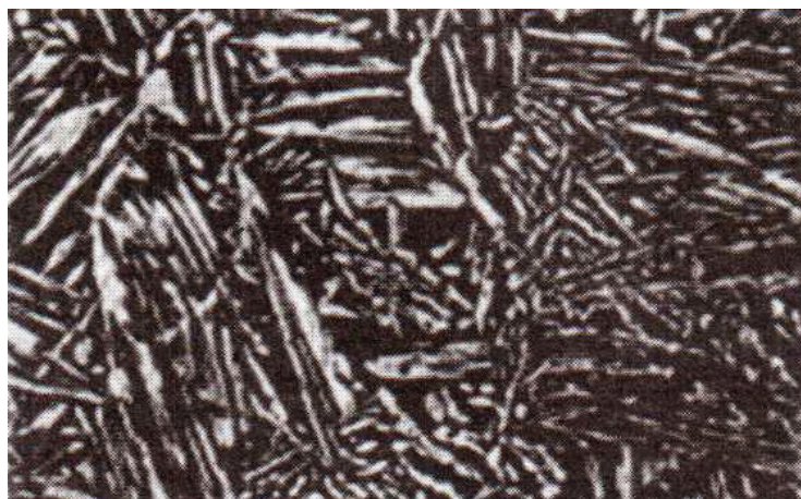
Рис. 2.3. Литая ( \alpha + \beta )-латунь ( \times 100 )
