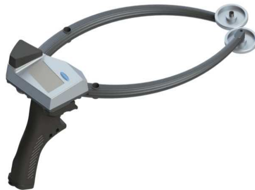
Рисунок 6 – Мерная вилка Rasal II BT
