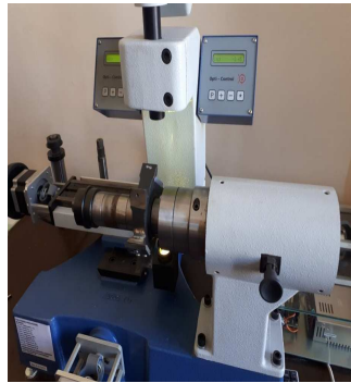
Рисунок 3 – Настройка фрезы с экспериментальным ножом
