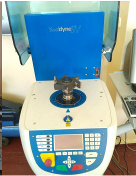
Рисунок 3 – Настройка фрезы с экспериментальным ножом
