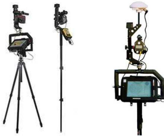
Рисунок – Комплекты приборов Field-Map для инвентаризации леса
