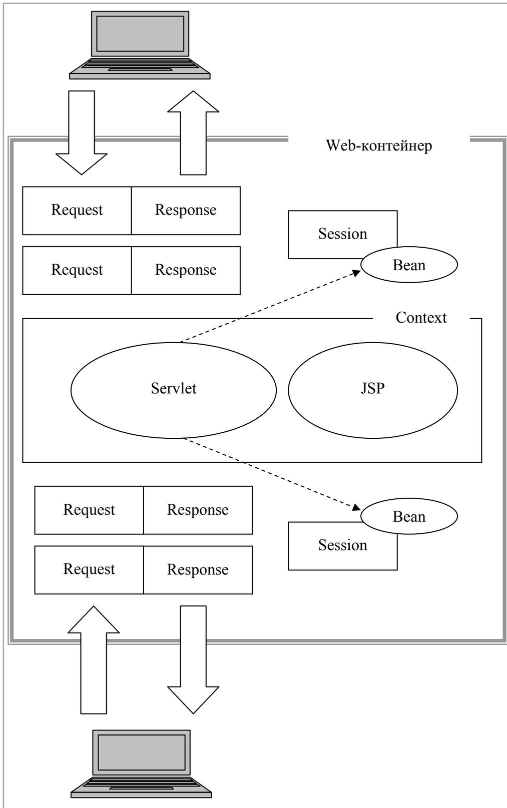
Рис. 5.30. Структурная схема многопользовательского web-приложения
