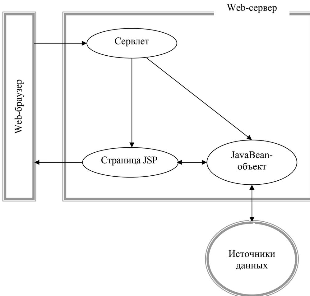
Рис. 4.2. Архитектура JSP Model 2
