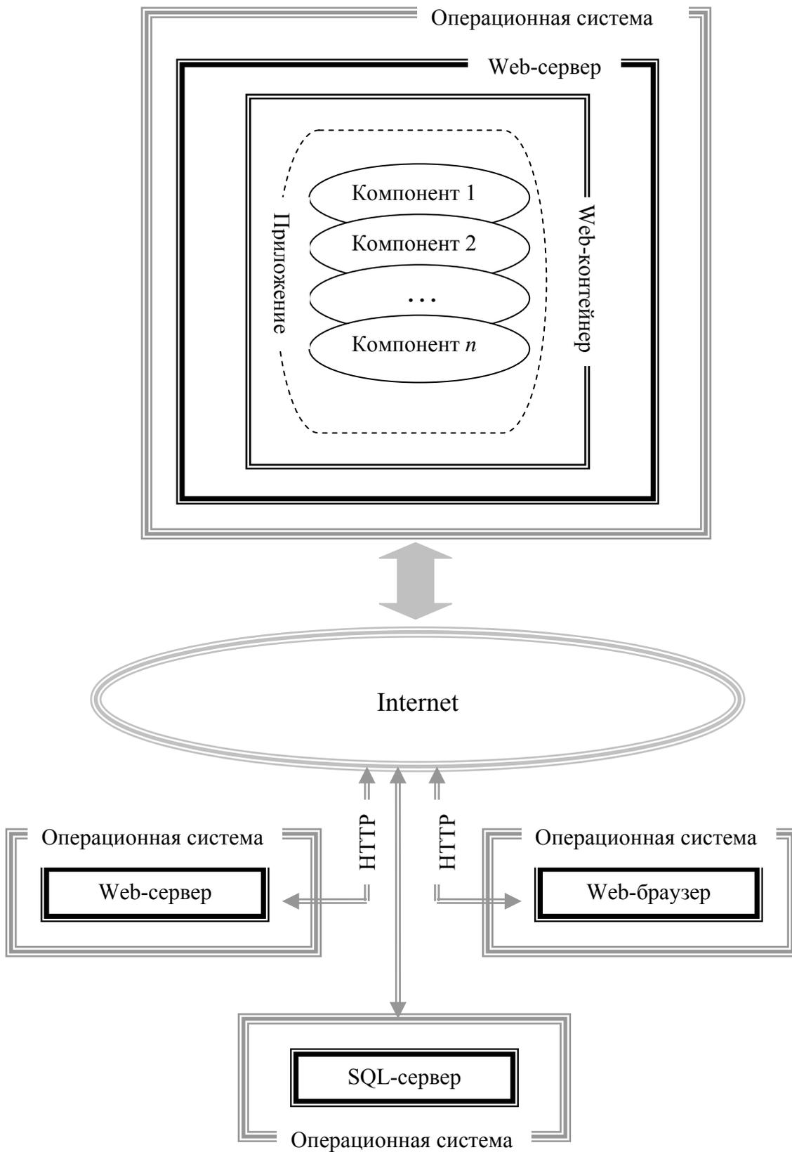
Рис. 2.1. Архитектура программной системы WStudy
