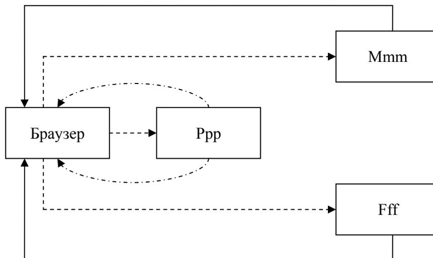
Рис. 5.18. Схема взаимодействия сервлетов при переадресации запроса
