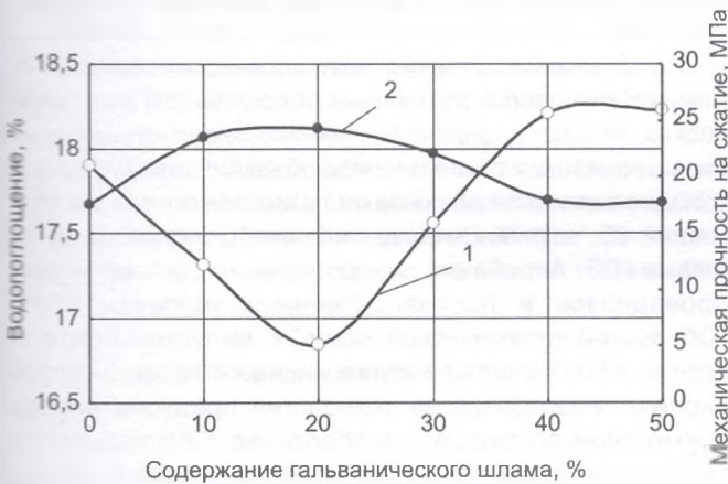
Рис. 2. Зависимость водопоглощения (1) и механической прочности на сжатие (2) образцов, обожженных при температуре 1050 °С, от содержания шлама ГСЗ
