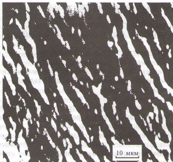
Рис. 2. РЭМ-изображение структуры поверхности резины с вольфрамовым покрытием, нанесенным методом ИАНПУС ( E = 20 \text{ кэВ} ).
