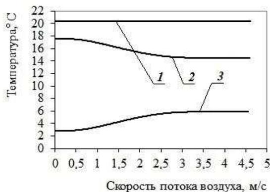
Рис. 1. Зависимость показаний психрометра от скорости циркуляции сушильного агента:
