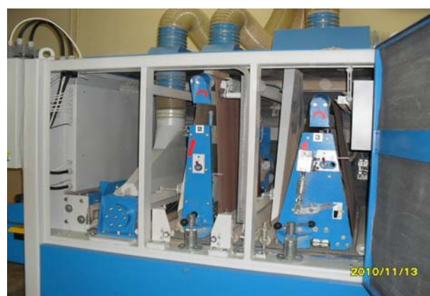
Рис. 2. Базовая конфигурация калибровально-шлифовального узла
