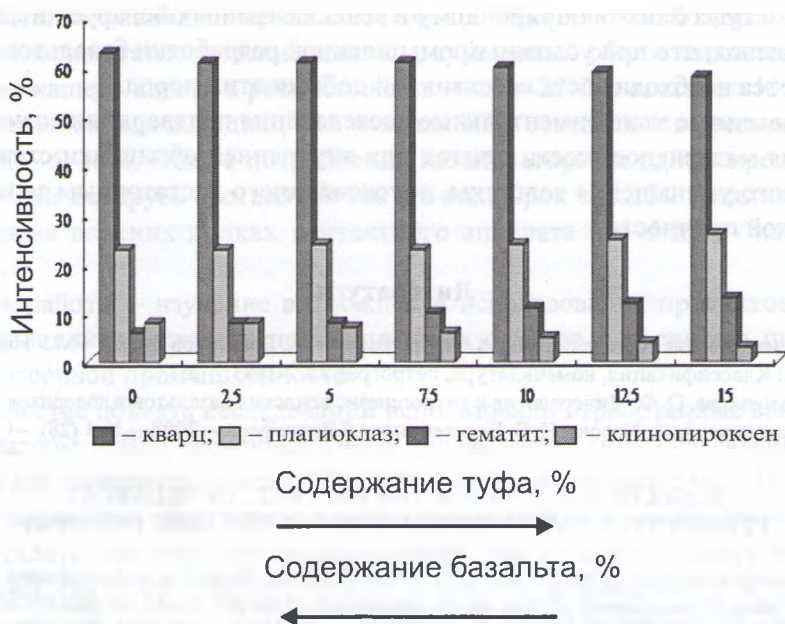
Рис. 2. Зависимость интенсивности дифракционных максимумов кристаллических фаз от содержания туфа, введенного взамен базальта
