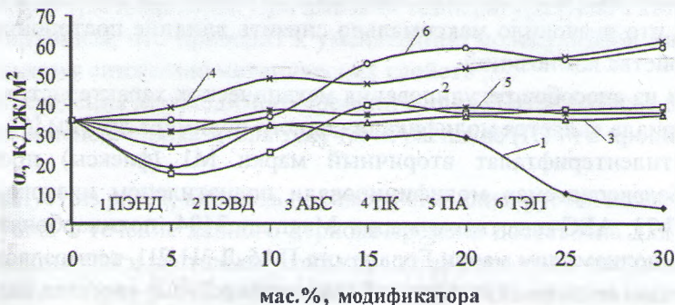
Рис. 3. Зависимость ударной вязкости композиции от содержания полимерного модификатора
